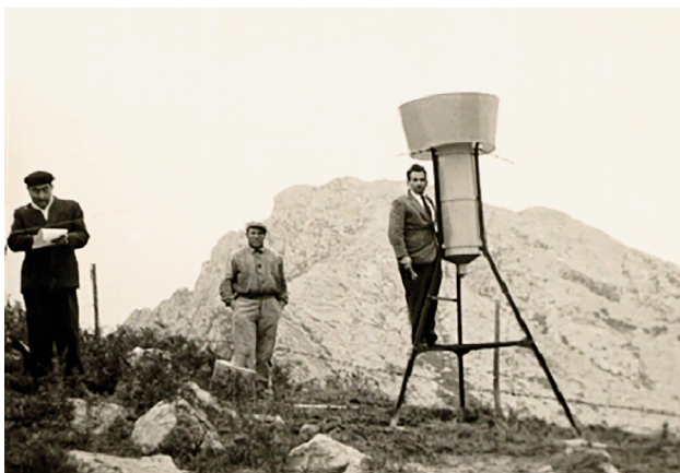
Figura 10. Pluviometro totalizzatore presso la cima del Monte Capanne all'Isola d'Elba nei primi anni Settanta del secolo scorso (Archivio fotografico dell'Ufficio Idrografico dell'Arno con sede a Pisa).
