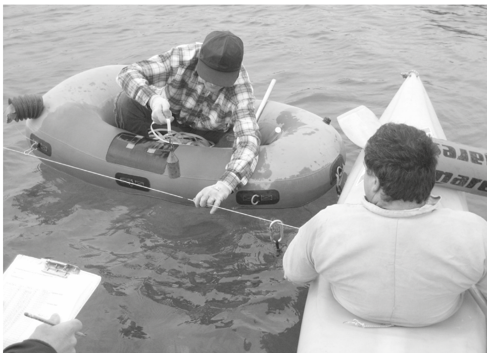
Figura 3. Posizionamento su un punto di misura lungo il cavo teso attraverso il lago. L'immagine riprende il momento precedente alla calata del peso verso il fondo.
