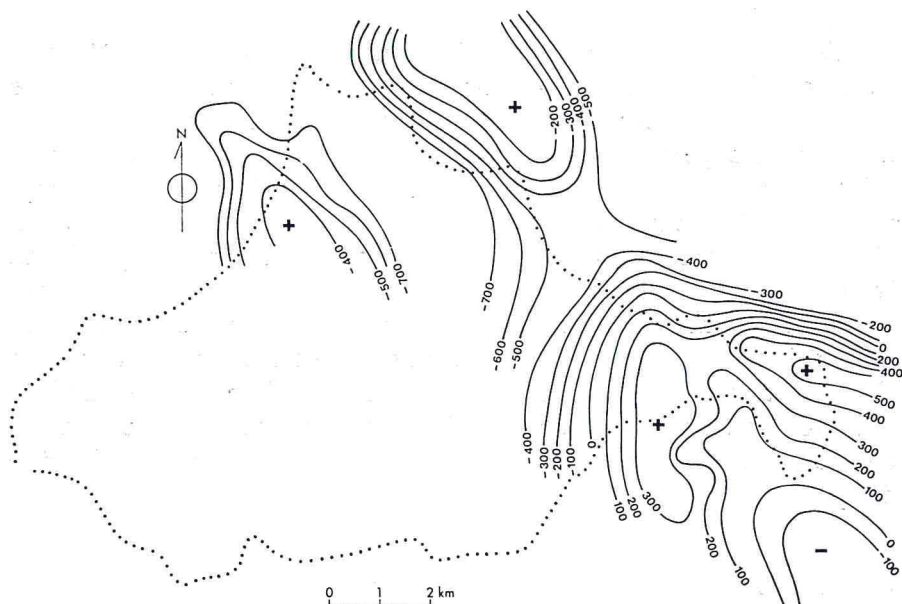
Fig. 6 - Isobate del tetto del basamento quarzitico-filladico, m s.l.m.
